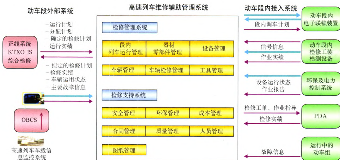
图1 德国动车组维修辅助管理软件结构图
