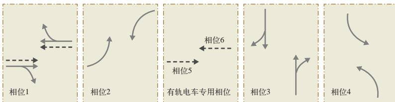
图3 四相位信号控制示意图
