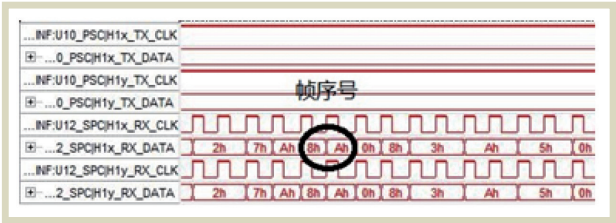
图7 通信停止时逻辑分析仪数据
