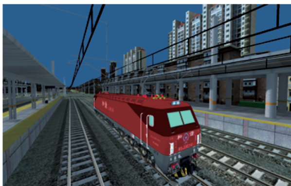
图2 HXD 3 D型电力机车及其场景三维模型
