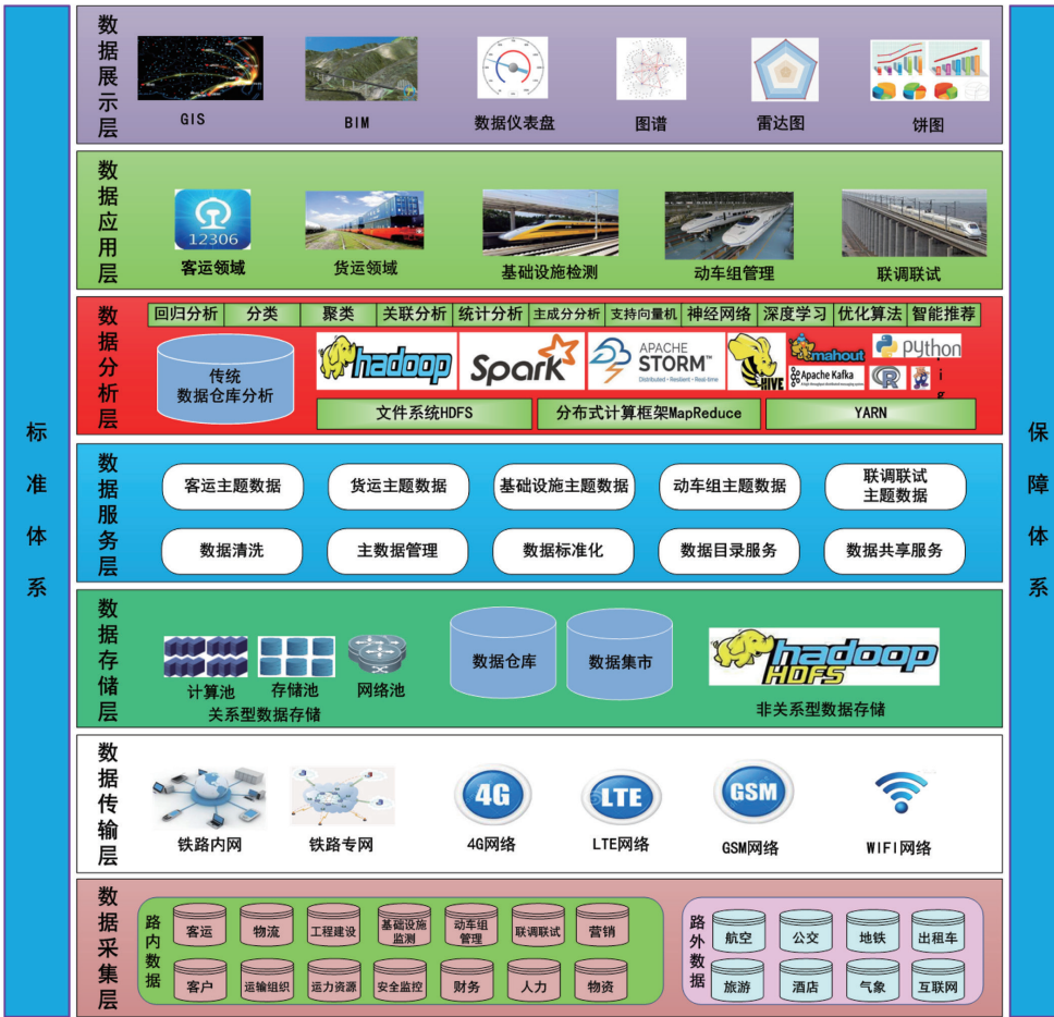
图1 铁路大数据平台总体架构
