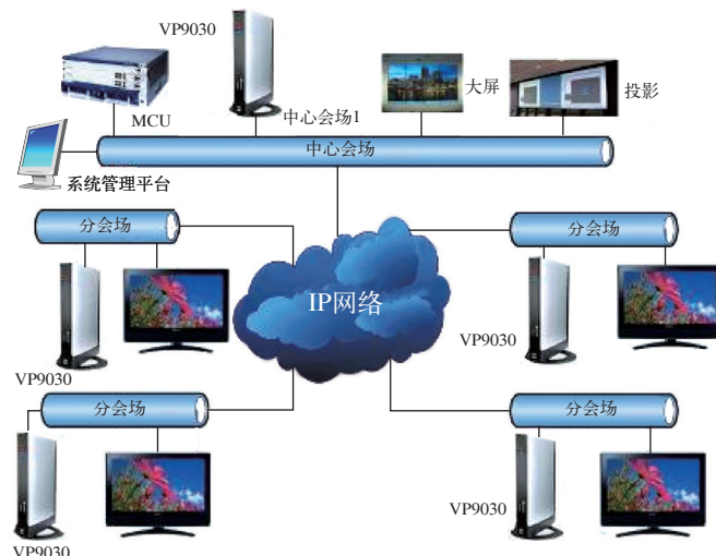
图1 视频会议系统技术架构
