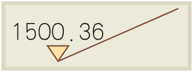
图6 图纸标注方式（两端标注）
