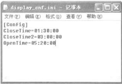
图3 定时开关显示器程序的时间配置文件
