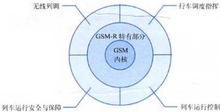
图 3 GSM、GSM-R 及铁路应用的衍生关系图
