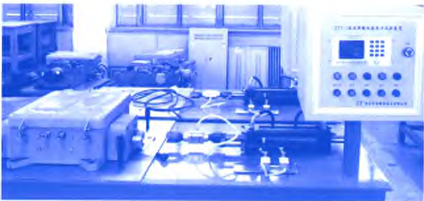
图 3 液压转辙机挤脱力测试仪外型图
