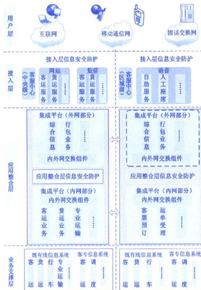
图1 铁路客户服务中心逻辑架构图
