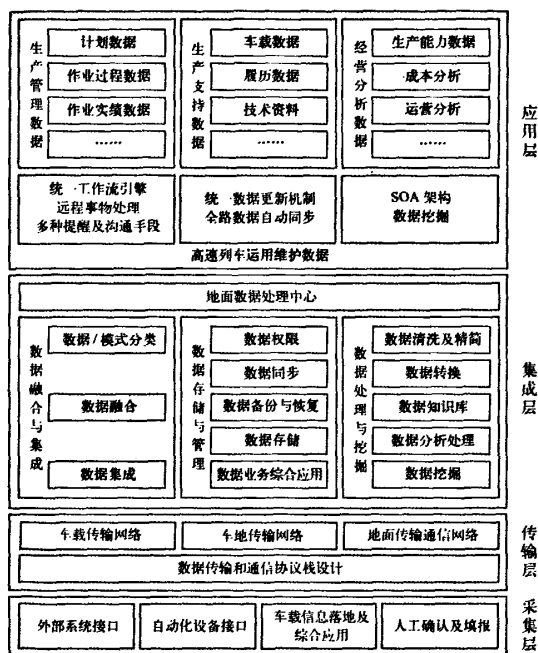
图1 高速列车运用维护数据应用架构图
