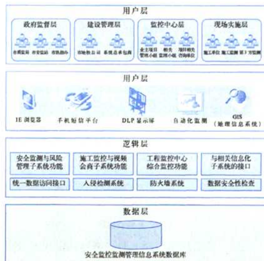
图2 安全管理和监控监测信息系统数据结构层次设计
