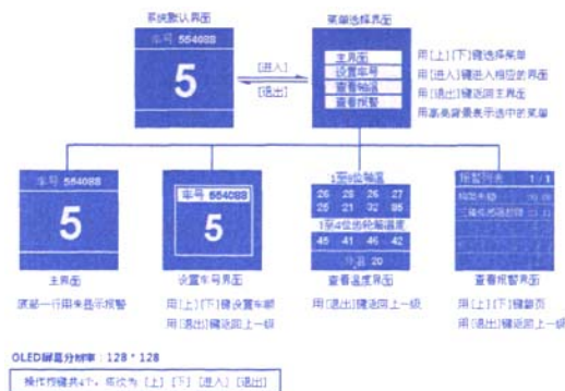
图2 OLED在列车故障诊断中的应用
