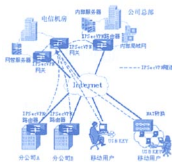
图 2 IPSecVPN 组网方式 2
