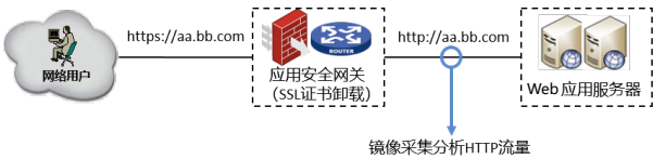
图2 应用安全网关 SSL 证书集中卸载
