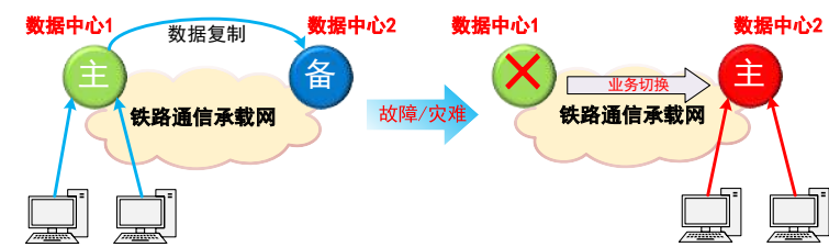
图2 主备模式数据中心工作机制
